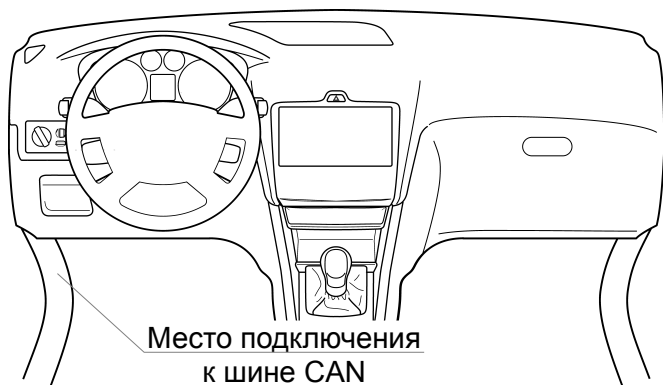
Рисунок 2. Рекомендуемое место подключения к CAN.
