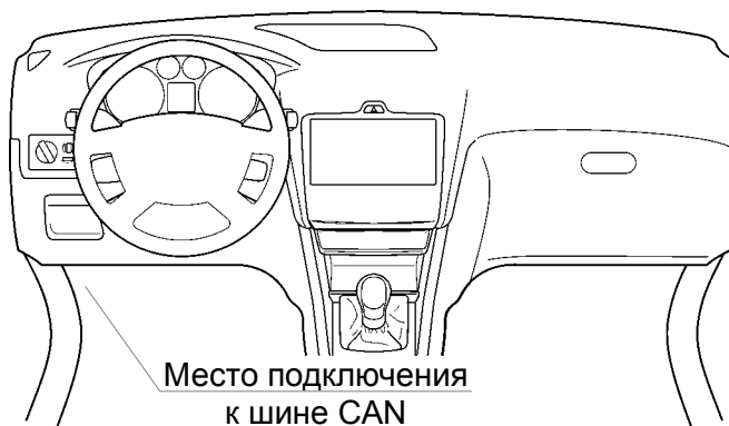
Рисунок 2. Рекомендуемое место подключения к шине CAN.
